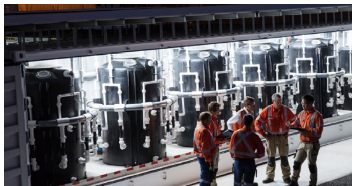
Figur 1: Foto på en SAFF anläggning. Det man ser är fem kolonner för första stegs fraktionering samt att man skimtar behållaren för det andra fraktioneringssteget.
