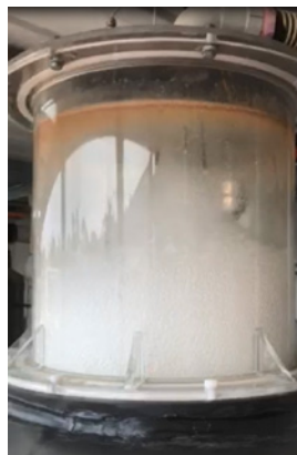
Figur 3: Foto taget vid utförande av det andra fraktioneringssteget i en fullskalig anläggning. Här ser man hur det torra skummet bildas och avlägsnas med vakuüm.
