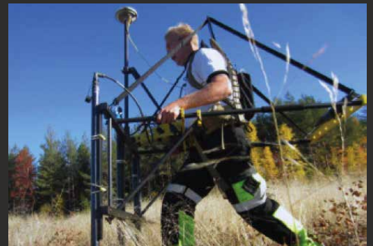
Manuell dataloggning (3 GPS sonder). Lämpar sig för framkomliga kuperade områden.
