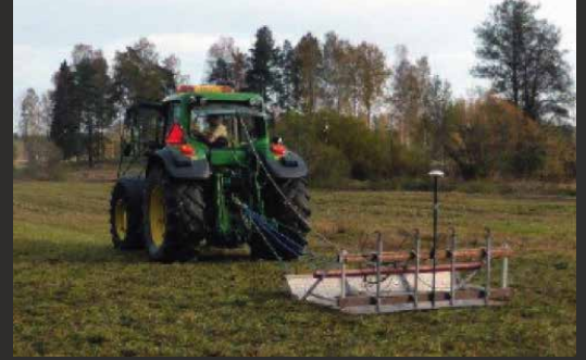
Maskinell dataloggning (4 GPS sonder). Lämpar sig på plana ytor mindre än 10 hektar.
