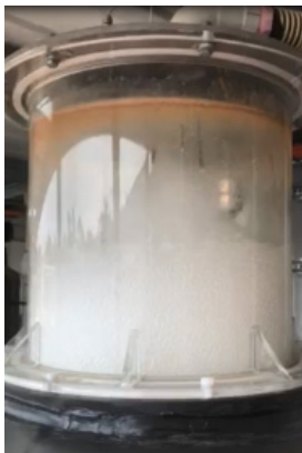
Figur 3: Foto taget vid utförande av det andra fraktioneringssteget i en fullskalig anläggning. Här ser man hur det torra skummet bildas och avlägsnas med vakuum.
